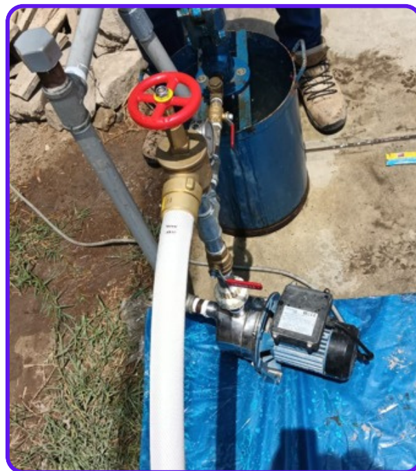
Pruebas Hidrostática de Mangueras Contra Incendios
